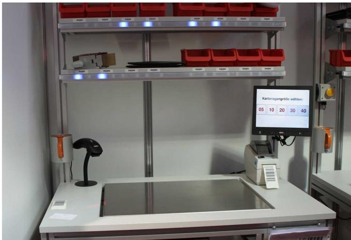
Abb.1: pack2light Packtisch mit LEDs und Touchscreen
